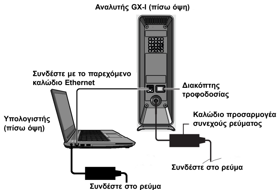
Εικόνα 2-5. Σύνδεση του αναλυτή GX-I σε φορητό υπολογιστή
