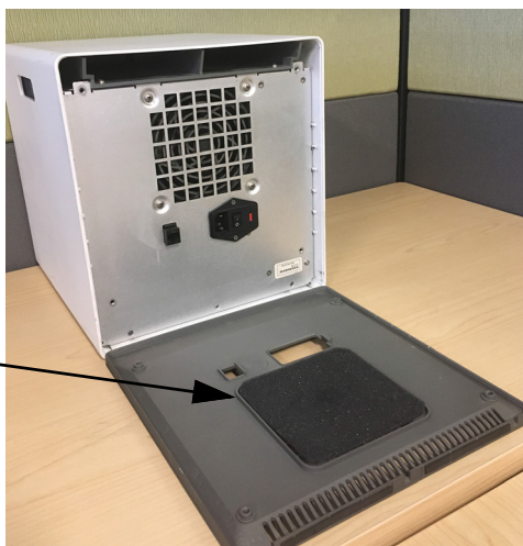
Εικόνα 9-15. Φίλτρο αφρώδους υλικού σε παλαιότερο GX-IV
