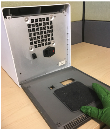
Εικόνα 9-16. Επανατοποθέτηση φίλτρου αφρώδους υλικού σε παλαιότερο GX-IV
