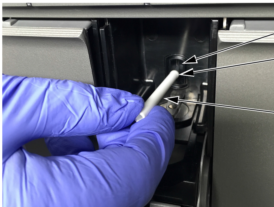
Εικόνα 9-7. Εισαγωγή βούρτσας καθαρισμού στη σχισμή του I-CORE
