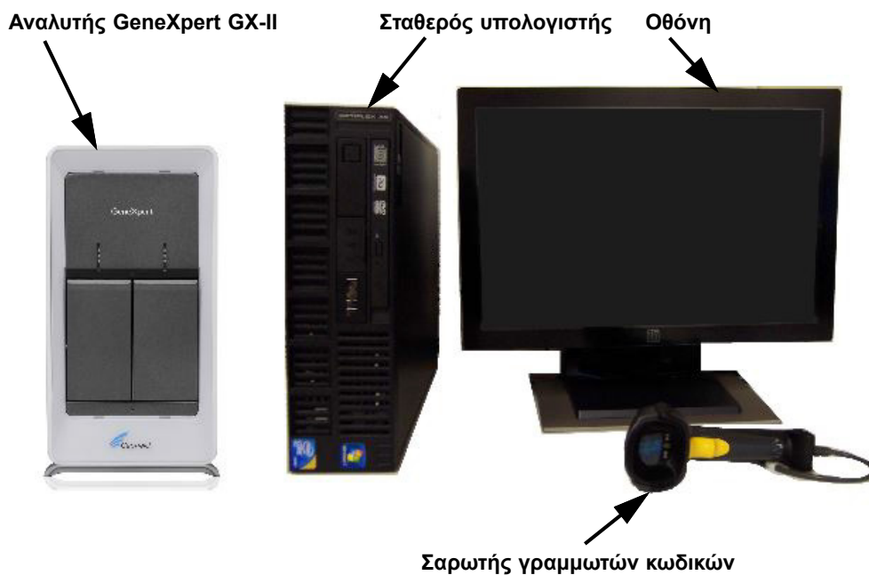
Εικόνα 1-4. Εξαρτήματα υλικού του GeneXpert GX-II (Εμφανίζονται με τον σταθερό υπολογιστή)
