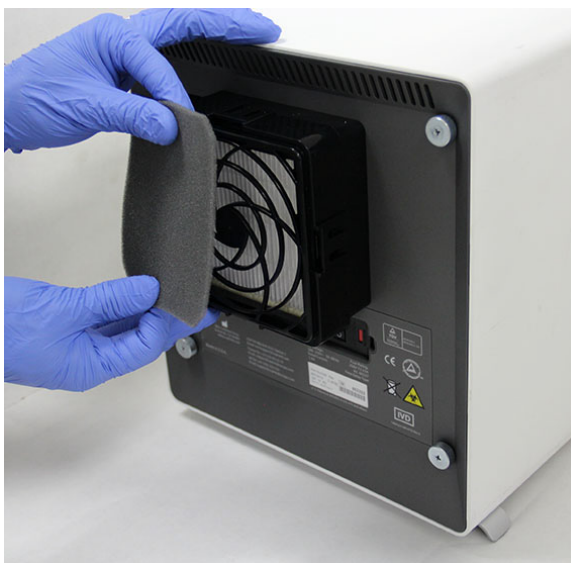
Εικόνα 9-26. Αφαίρεση του προφίλτρου
