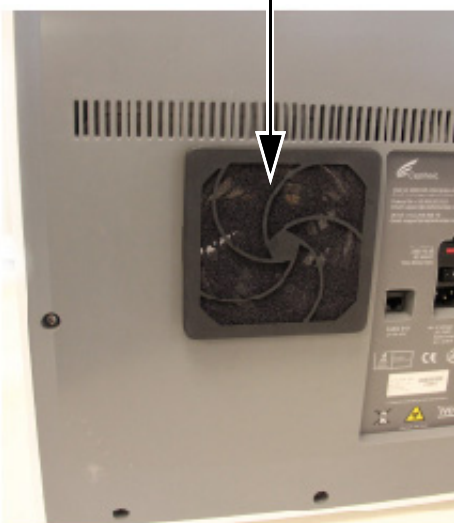
Εικόνα 9-23. Αντικατάσταση του φίλτρου και του προστατευτικού
