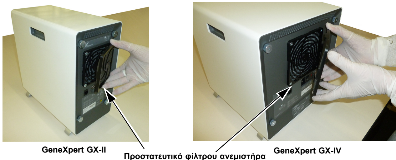
Εικόνα 9-9. Αφαίρεση του προστατευτικού του φίλτρου του ανεμιστήρα
