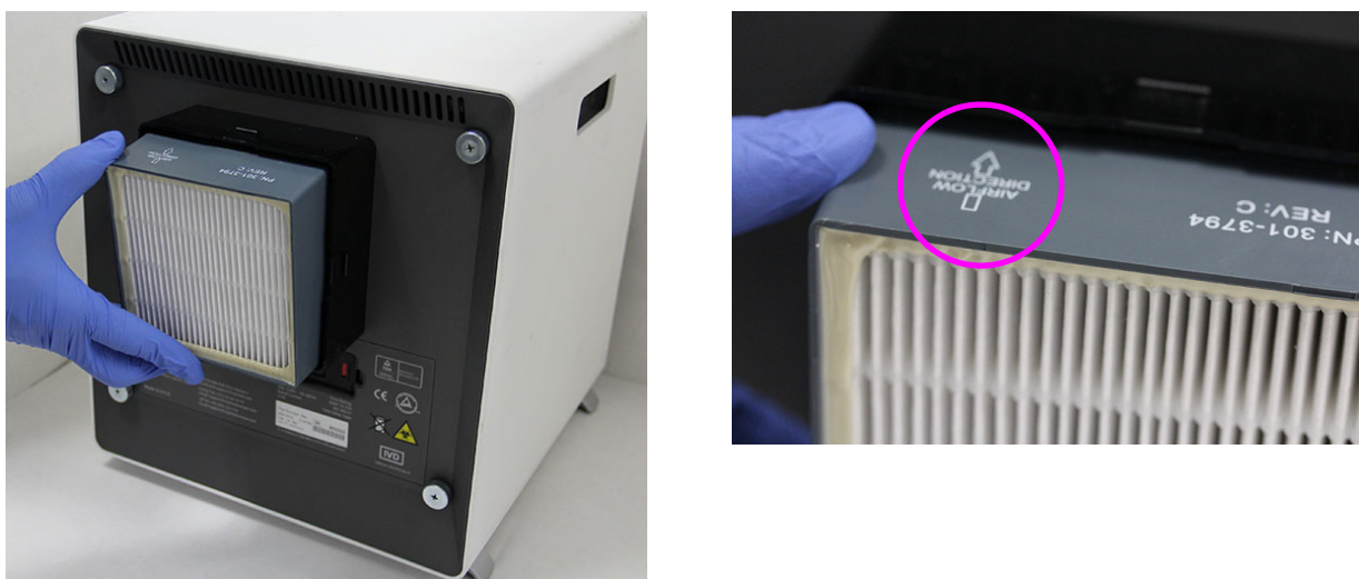
Εικόνα 9-29. Αντικατάσταση του φίλτρου HE
