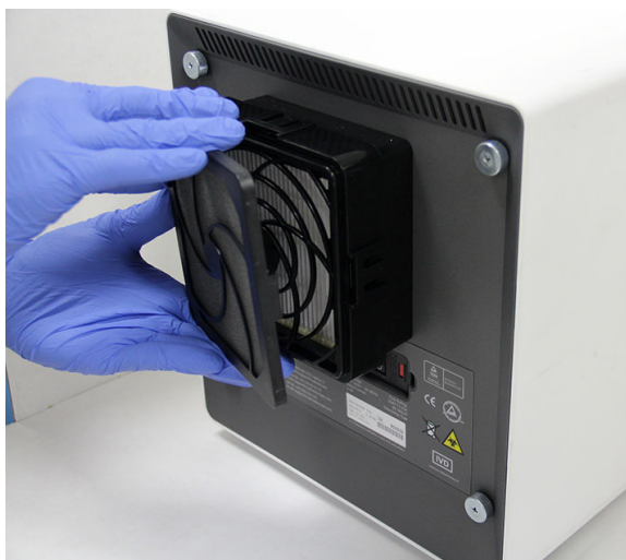
Εικόνα 9-25. Αφαίρεση του συγκρατητήρα του προφίλτρου
