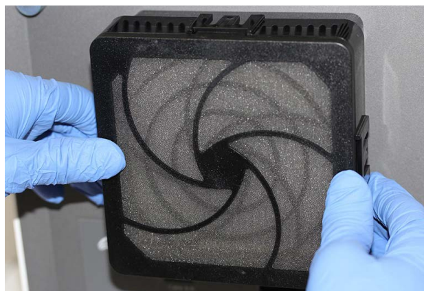
9-31 pav. Pirminio filtro ir pirminio filtro laikiklio keitimas
