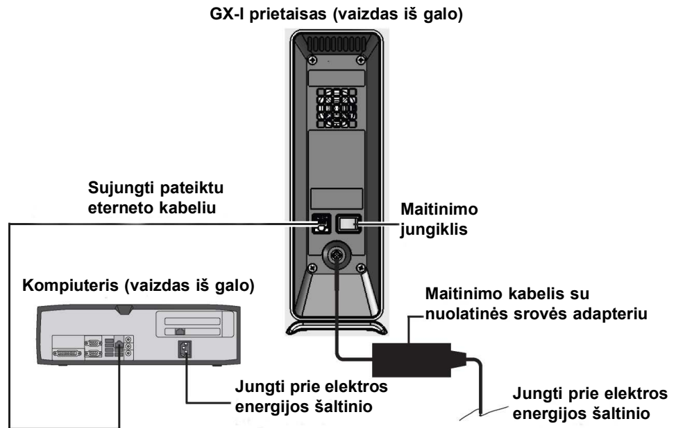
2-1 pav. GX-I prietaiso prijungimas prie stalinio kompiuterio
