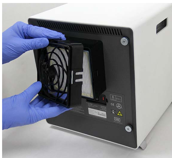
9-27 pav. DV filtro laikiklio nuėmimas
