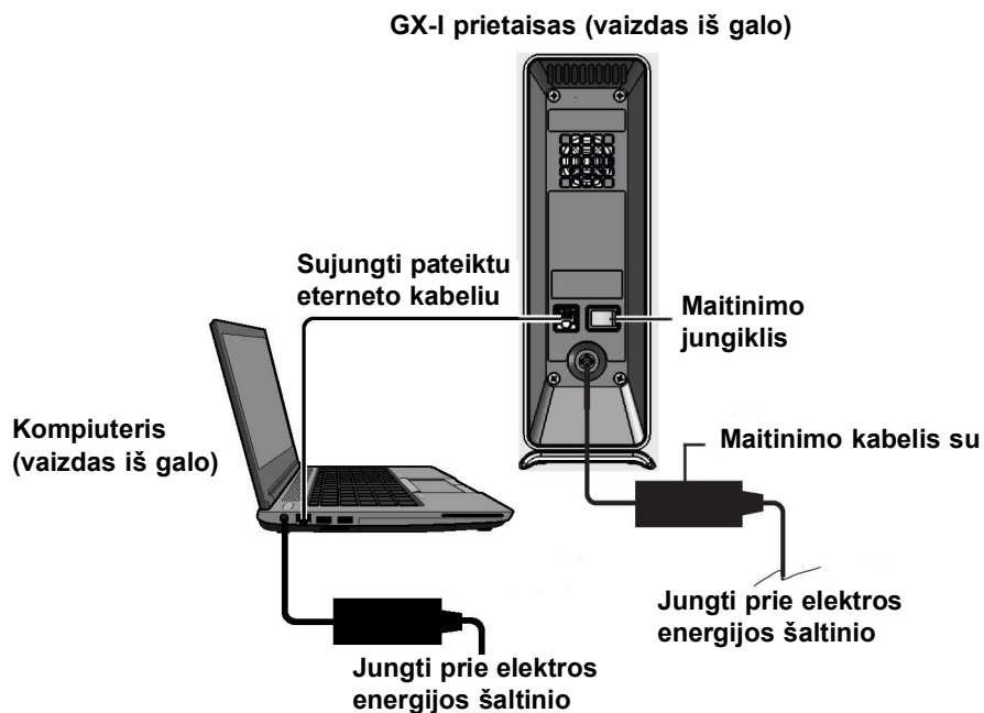
2-5 pav. GX-I prietaiso prijungimas prie nešiojamojo kompiuterio
