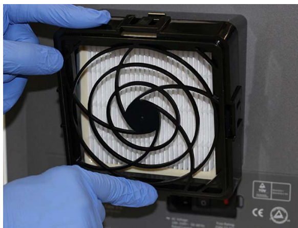
9-30 pav. DV filtro laikiklio keitimas
