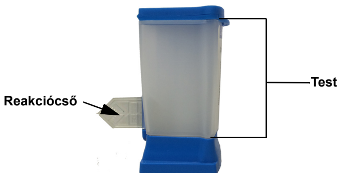
5-31. ábra A kazetta testét és reakciócsövét bemutató ábra
