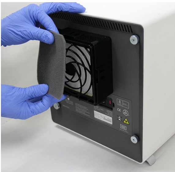
9-26. ábra Az előszűrő eltávolítása
