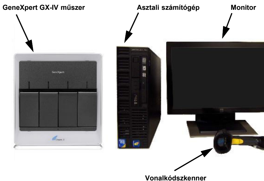
1-7. ábra GeneXpert GX-IV Hardverkomponensek (asztali számítógéppel együtt megjelenítve)
