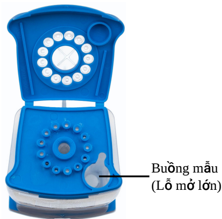
Hình 2. Hộp xét nghiệm Xpert HPV v2 (Mặt nhìn từ trên xuống)
