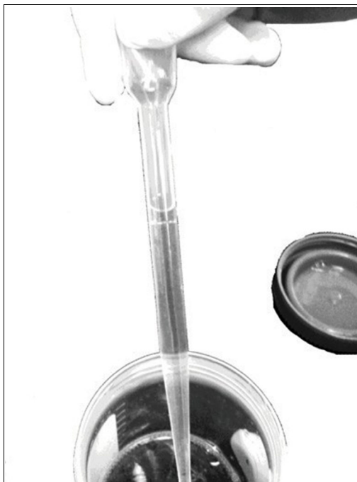
Рисунок 4. Аспирация до отметки на пипетке
