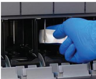
7. Humedeça um pano que não largue pelos com uma solução de etanol a 70% ou etanol desnaturado.
