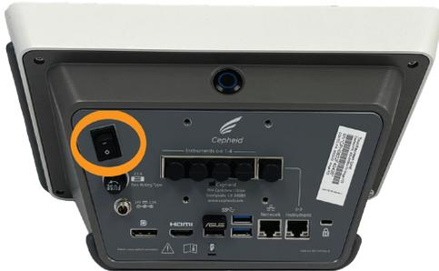
3. Coloque o interruptor na parte de trás do equipamento na posição **Desligado** (OFF). A luz azul no painel frontal irá apagar-se.
