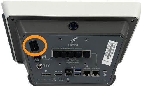
3. Den Schalter auf der Instrumentenrückseite in die Stellung **AUS** bringen. Die blaue Leuchte an der Frontplatte erlischt.
