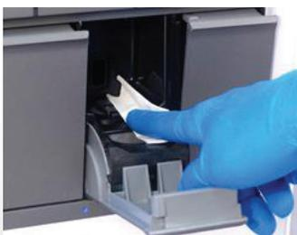
6. Befeuchten Sie ein flusenfreies Wischtuch mit einer 1:10-Lösung einer haushaltsüblichen Chlorbleiche. Kolbenstange und das gesamte Innere des Kartuschenfachs drei Mal mit verdünnter Chlorbleiche abwischen und die Bleiche dabei jeweils 2 Minuten einwirken lassen.
