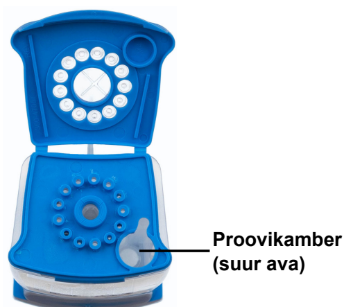
Joonis 2. Xpert HPV v2 kassett (ülaltvaade)
