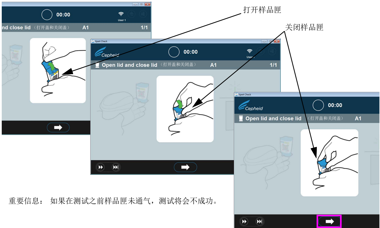
图 2-16. 打开和关闭样品匣盖对样品匣通气 - 动画屏幕
