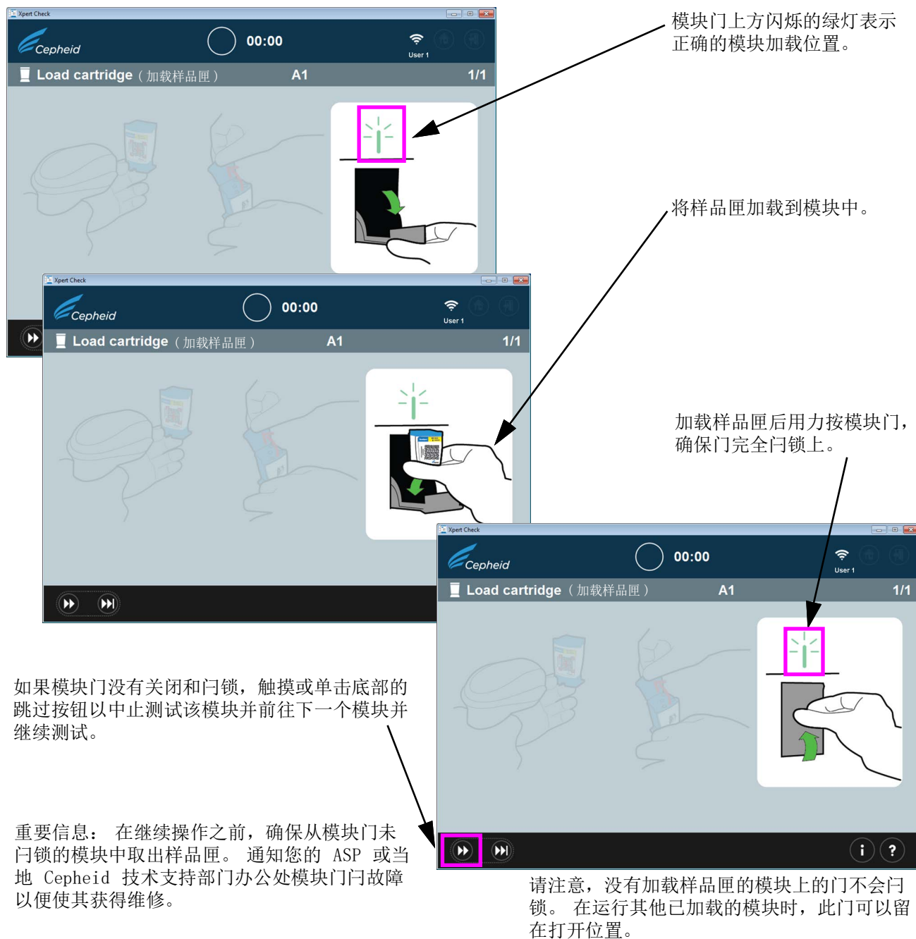
图 2-17. 将样品匣加载到模块中
