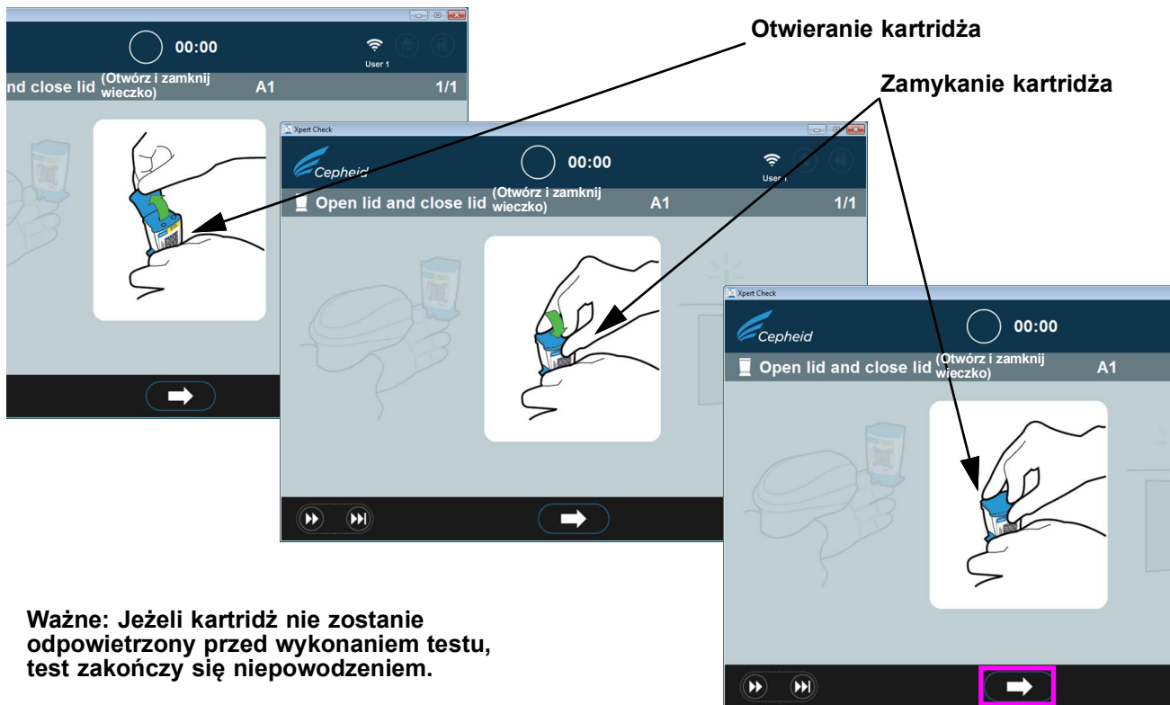
Ilustracja 2-16. Odpowietrzanie kartridża przez otwarcie i zamknięcie wieczka kartridża — ekran animowany
