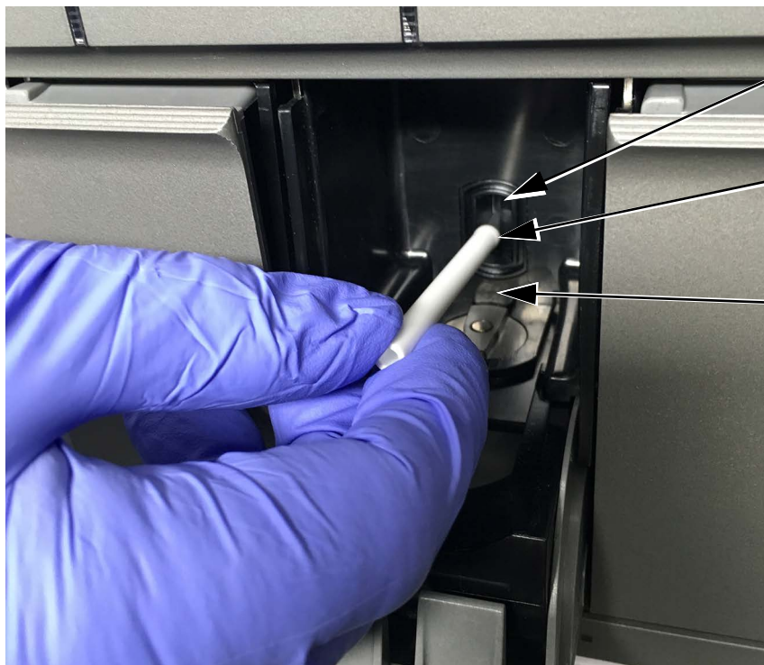
2-2 pav. Įdėkite valymo šepetėlį į „I-CORE“ plyšį
