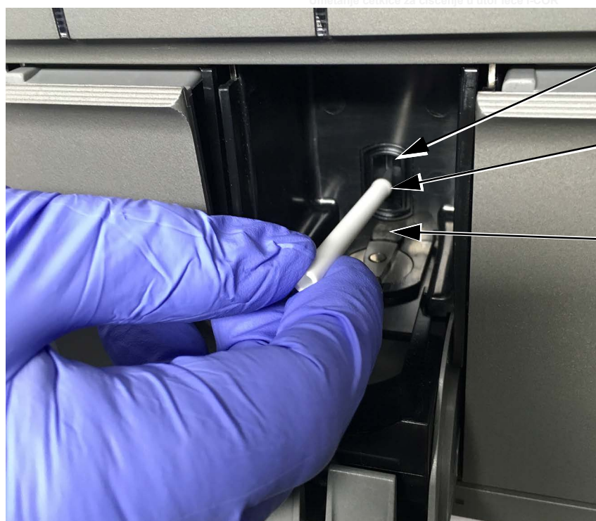
Slika 2-2. Umetanje četkice za čišćenje u utor leće I-CORE
