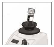
10. Pipeter la totalité du contenu de l'échantillon préparé dans la chambre à échantillon (grande ouverture).
