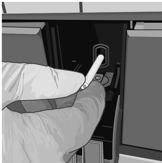
Εικόνα 72. Εισαγωγή βούρτσας καθαρισμού στη σχισμή της υπομονάδας I-CORE
