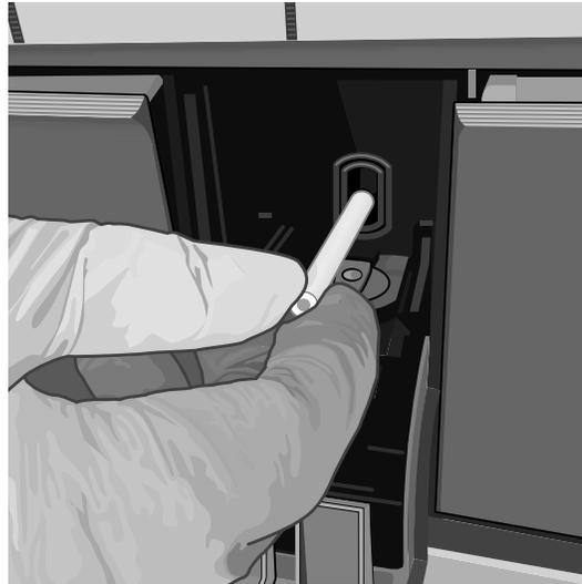
**Figure 72. Insertion de la brosse de nettoyage dans la fente du module I-CORE**
