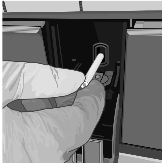
Afbeelding 72. De reinigingsborstel in de spleet voor de I-CORE-module steken
