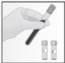
2. Añada 100 µl de PK (proteínasa K) al fondo de un tubo cónico nuevo de 50 ml. **Añada 50 µl de muestra de sangre.** Mezcle la muestra con un agitador vórtex a máxima velocidad de forma continua durante 3 segundos. Incube a temperatura ambiente durante 1 min.
