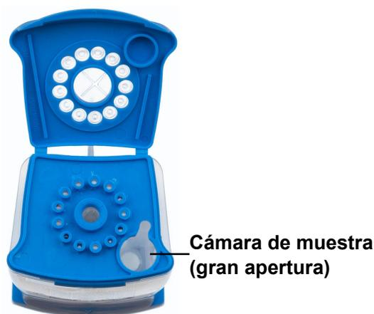
**Figura 4. Cartucho del ensayo HIV-1 Qual (vista superior)**
