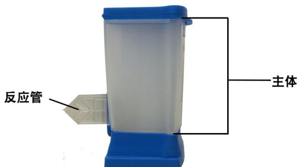
图 5-31. 显示出主体和反应管的样品匣
