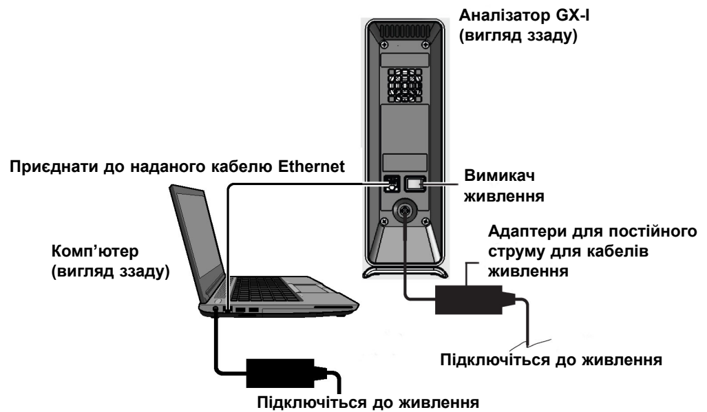
Малюнок 2-5. Підключення аналізатору GX-I до переносного комп'ютера
