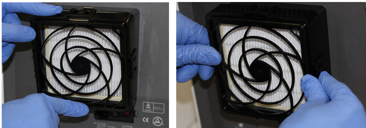
Малюнок 9-30. Заміна утримувача HE фільтра
