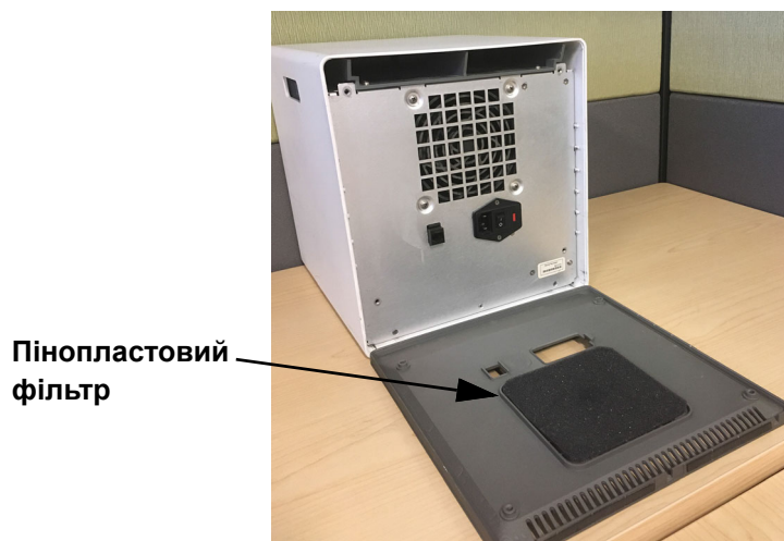
Рисунок 9-15. Пінопластовий фільтр у старій моделі GX-IV
