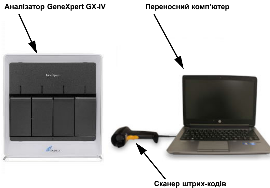
Малюнок 1-6. Апаратні компоненти GeneXpert GX-IV (представлені разом з переносним комп'ютером)
