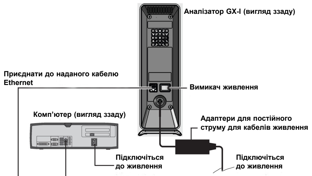
Малюнок 2-1. Підключення аналізатору GX-I до настільного комп'ютера
