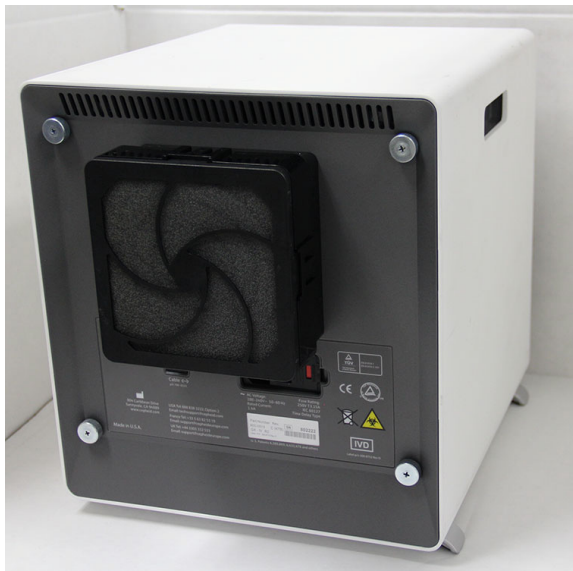
Рисунок 9-24. Анализатор GX-IV, установленный для доступа к фильтру
