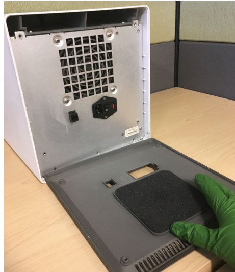
Рисунок 9-16. Замена поролонового фильтра в старых GX-IV
