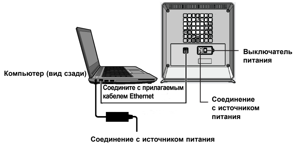
Рисунок 2-7. Подключение прибора GX-IV к портативному компьютеру
