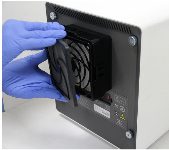
Рисунок 9-25. Снятие держателя предфильтра
