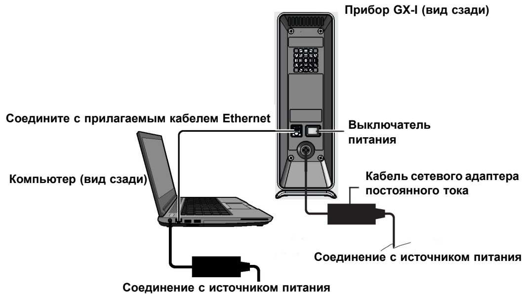
Рисунок 2-5. Подключение прибора GX-I к портативному компьютеру
