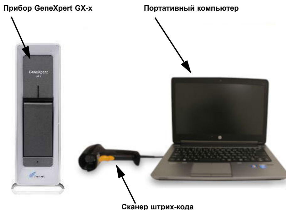
Рисунок 1-2. Компоненты аппаратного обеспечения GeneXpert GX-x
