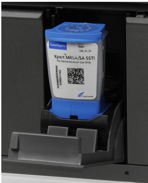
Рисунок 5-33. Картридж GeneXpert, установленный на площадке пола отсека модуля
