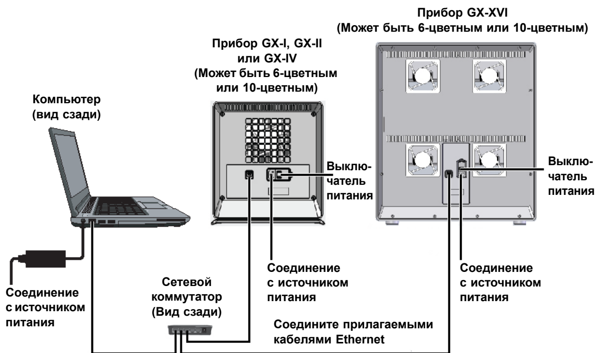
Рисунок 2-10. Подключение нескольких приборов к переносному компьютеру
