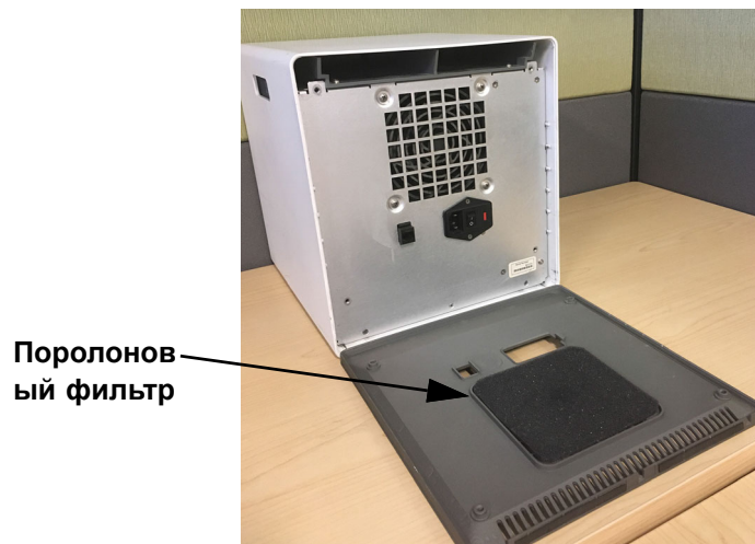
Рисунок 9-15. Поролоновый фильтр в старых GX-IV
