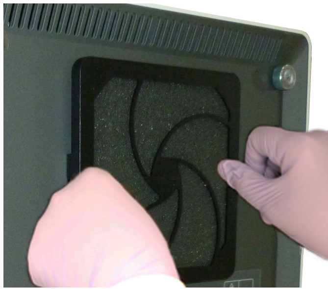
GX-IV: Pressionar as partes laterais no lugar
