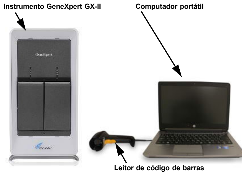
Figura 1-4. Componentes do hardware do GeneXpert GX-II (apresentado com o computador portátil)
