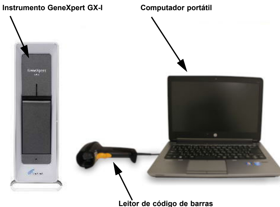
Figura 1-2. Componentes do hardware do GeneXpert GX-I (apresentado com o computador portátil)
