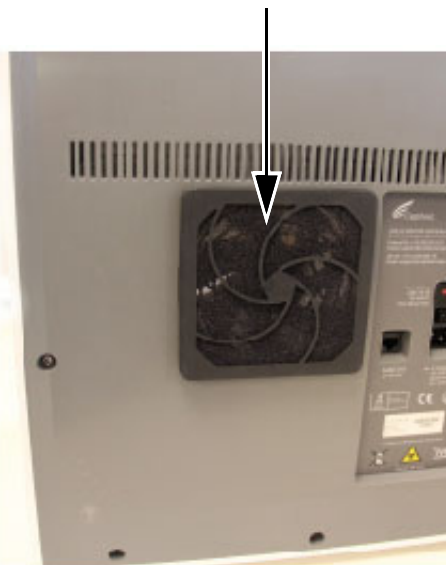
Ilustracja 9-23. Wymiana filtra i osłony
