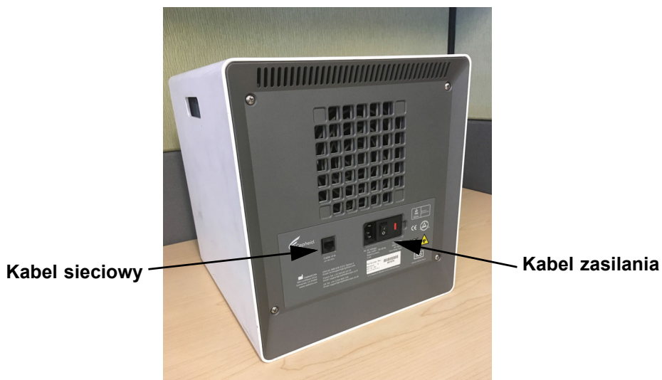
Ilustracja 9-13. Lokalizacje kabla sieciowego i zasilania w starszej wersji aparatu GX-IV
