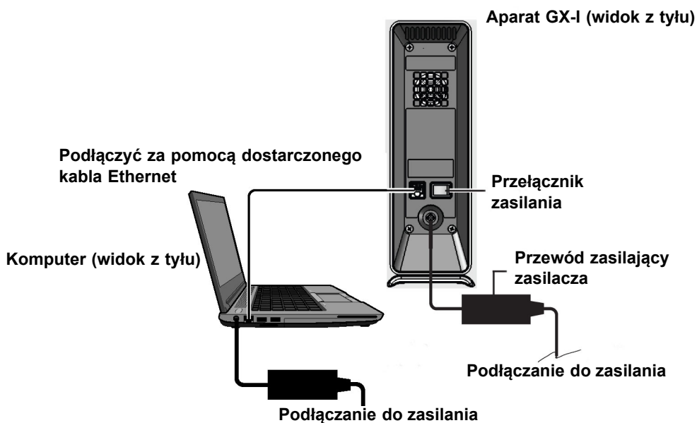
Ilustracja 2-5. Podłączenie aparatu GX-I do laptopa
