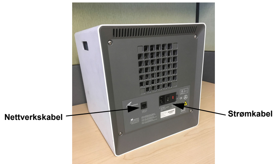
Figur 9-13. Plassering av nettverkskabel og strømkabel på eldre GX-IV
