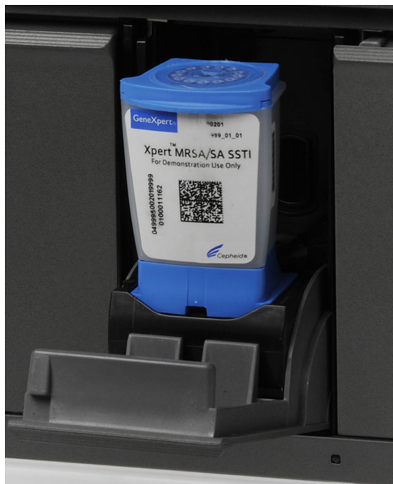
Figur 5-33. GeneXpert-patron, plassert helt bak på bunnen av modulrommet
