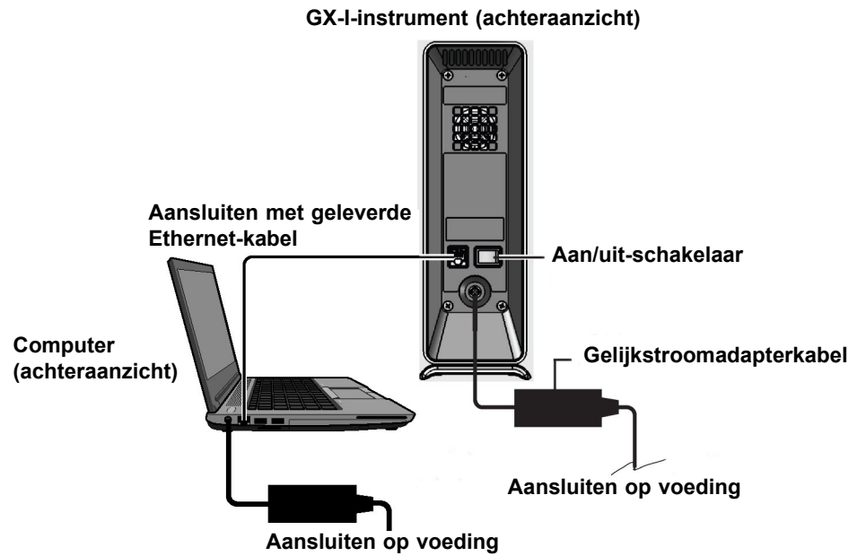
Afbeelding 2-5. Het GX-I-instrument aansluiten op de laptopcomputer
