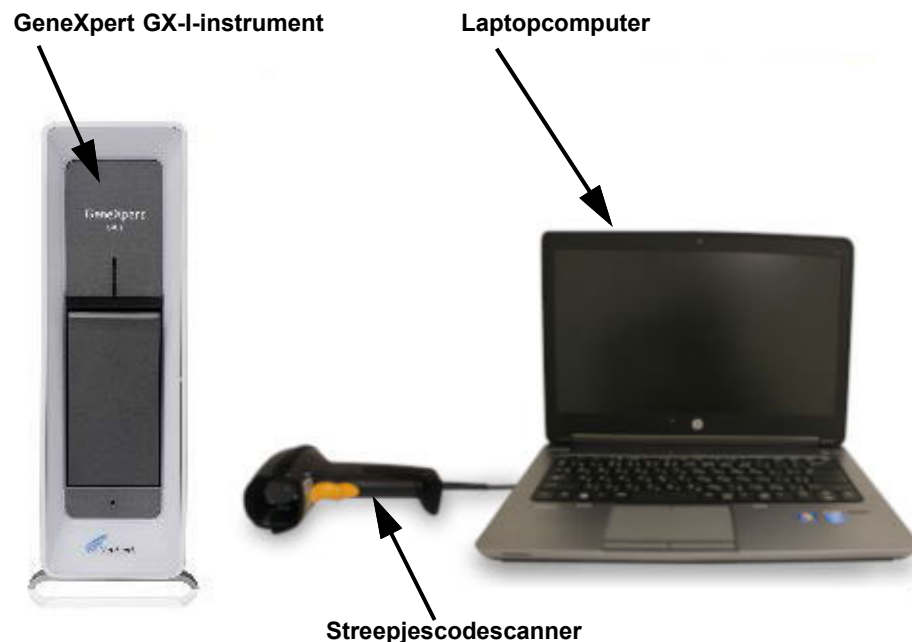
Afbeelding 1-2. GeneXpert GX-I-hardwarecomponenten (getoond met de laptopcomputer)
