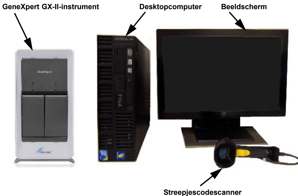
Afbeelding 1-5. GeneXpert GX-II-hardwarecomponenten (getoond met de desktopcomputer)
