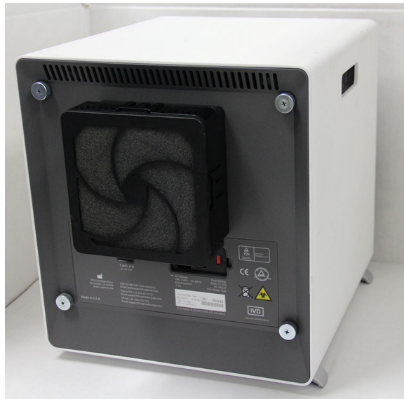
Afbeelding 9-24. GX-IV-instrument in positie voor toegang tot filter
