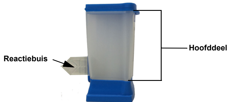
Afbeelding 5-31. Patroon met hoofddeel en reactiebuis
