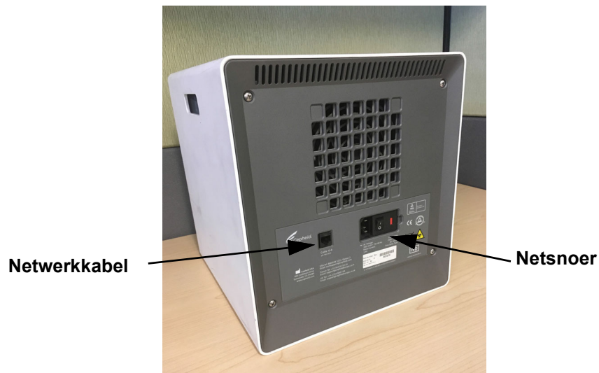
Afbeelding 9-13. Locaties netwerkkabel en netsnoer op oudere GX-IV
