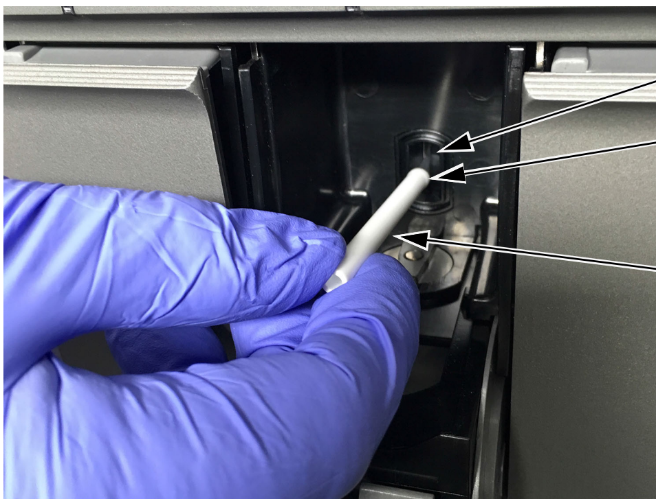
Afbeelding 9-7. De reinigingsborstel in de I-CORE-spleet steken
