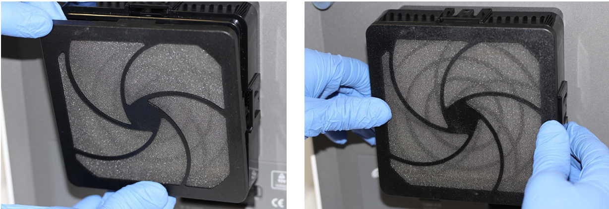
Afbeelding 9-31. Het voorfilter en de voorfilterhouder weer aanbrengen
