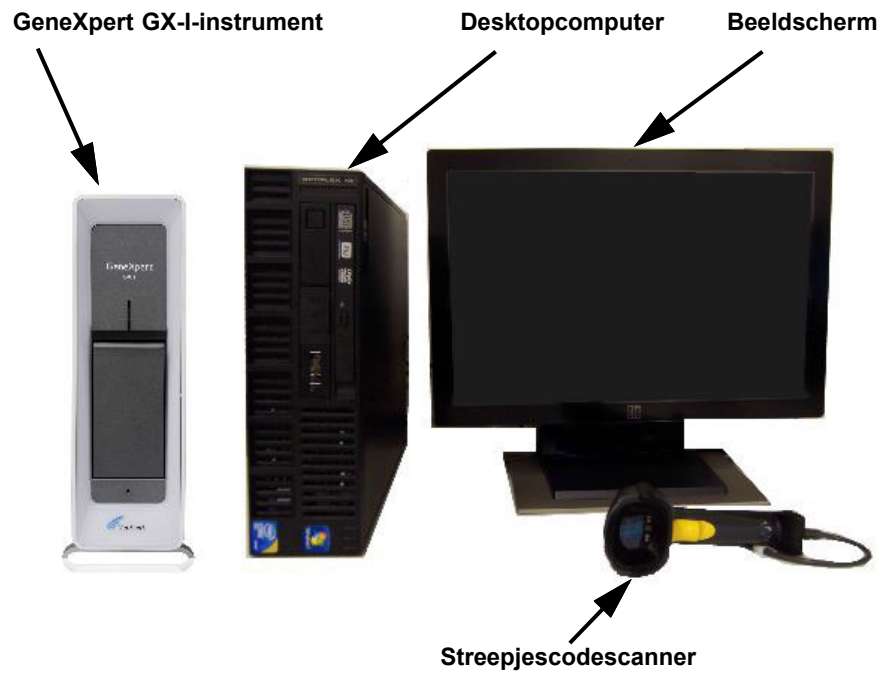
Afbeelding 1-3. GeneXpert GX-I-hardwarecomponenten (getoond met de desktopcomputer)
