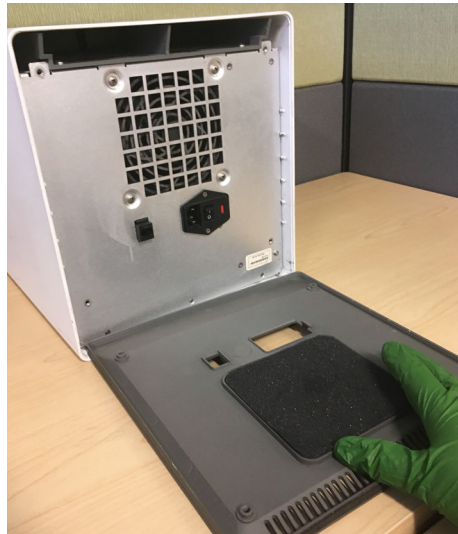
Afbeelding 9-16. Schuimfilter weer aanbrengen in oudere GX-IV
