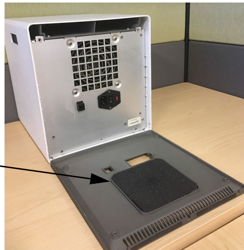
Afbeelding 9-15. Schuimfilter in oudere GX-IV
