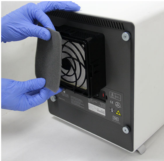
Afbeelding 9-26. Het voorfilter verwijderen
