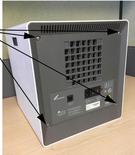
Afbeelding 9-14. Schroeven achterpaneel bij oudere GX-IV
