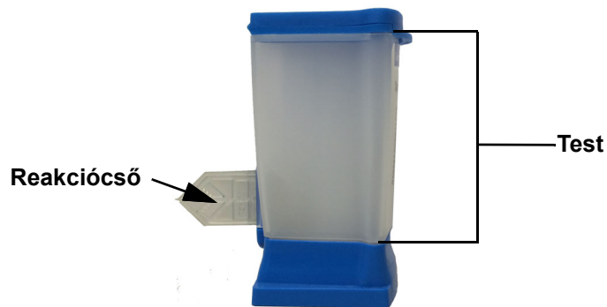
5-31. ábra A kazetta testét és reakciócsövét bemutató ábra
