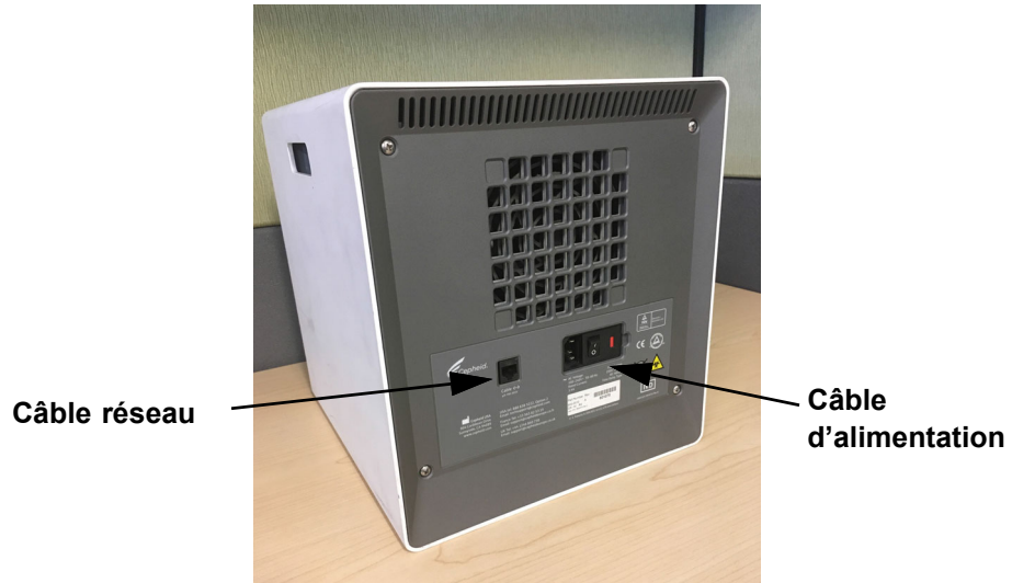
Figure 9-13. Emplacement du câble réseau et du câble d'alimentation sur les anciens GX-IV
