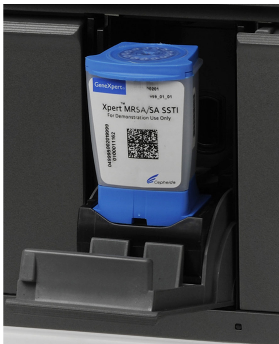
Figure 5-33. Cartouche GeneXpert positionnée au niveau du talon du fond du socle du module
