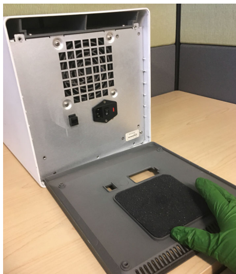
Figure 9-16. Remise en place du filtre en mousse des anciens GX-IV
