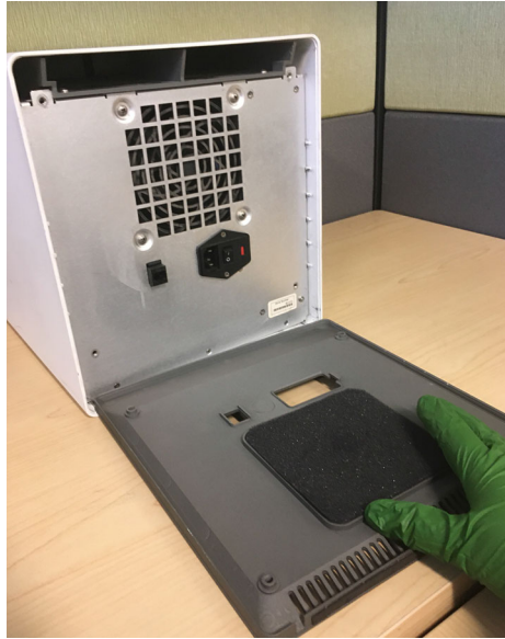
Kuva 9-16. Vaahtomuovisuodattimen vaihto vanhemmissa GX-IV-malleissa
