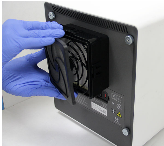
Kuva 9-25. Esisuodattimen pidikkeen irrotus
