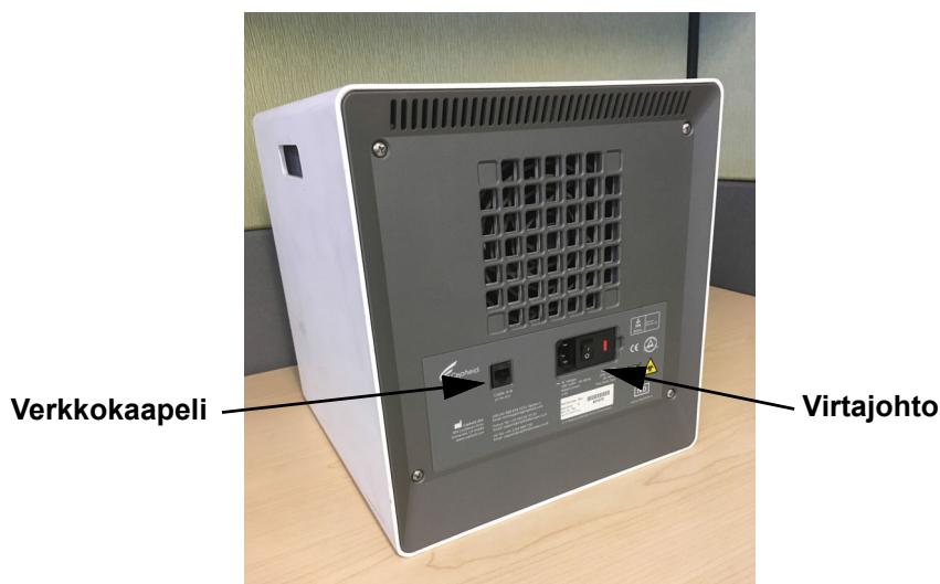
Kuva 9-13. Verkkokaapelin ja virtajohtojen sijainnit vanhemmissa GX-IV-malleissa
