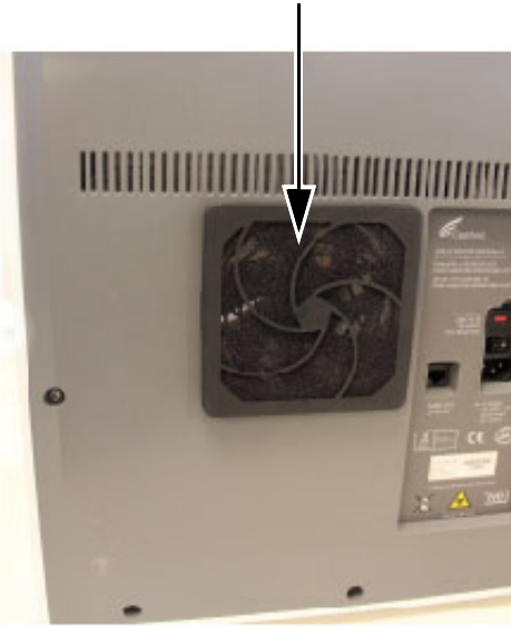
Kuva 9-23. Suodattimen ja suojuksen vaihtaminen
