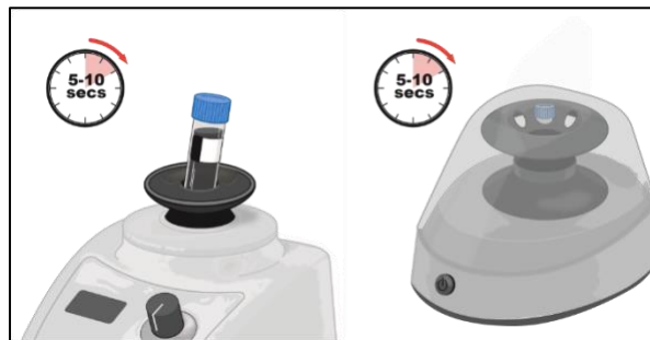
Figur 7. Vortexa MG Flexible-reaktionsblandning
