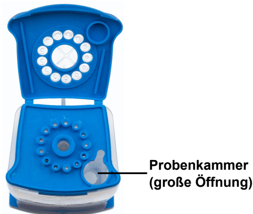
Abbildung 5. Xpert Xpress CoV-2/Flu/RSV plus-Kartusche (Draufsicht)
