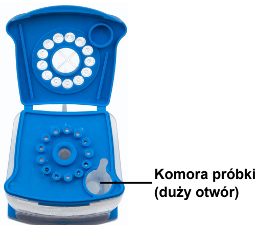
Ilustracja 5. Kartridż Xpert Xpress SARS-CoV-2 (widok z góry)
