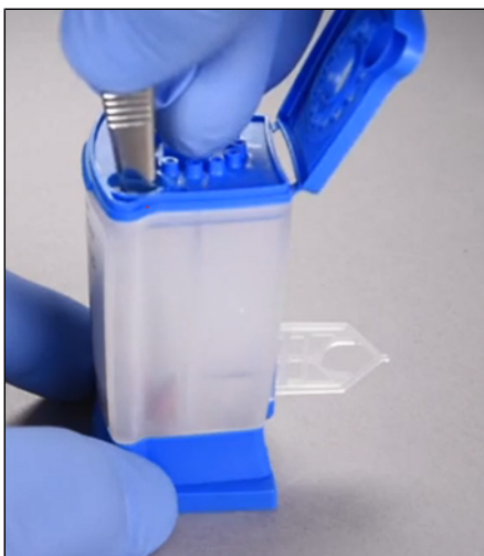
Рисунок 6. Складена СКК на дні призначеної для зразка камери
