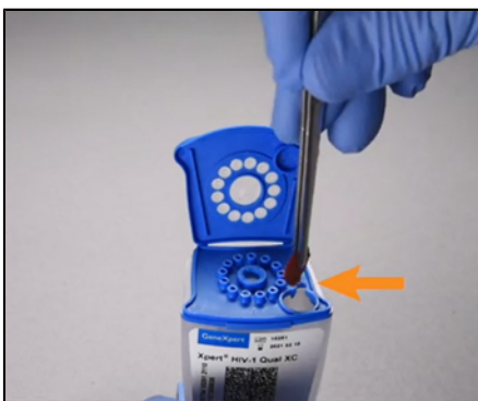
Obrázok 5. Vloženie DBS do komôrky na vzorky
