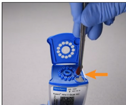
Εικόνα 5. Εισαγωγή της DBS στον θάλαμο δείγματος
