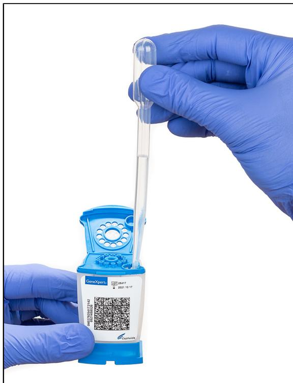
**Figura 6. Dispensación de la muestra licuada descontaminada al interior de la cámara de muestras del cartucho**
