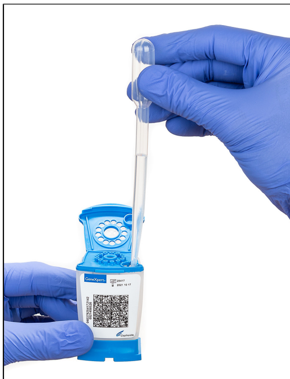
Slika 6. Razpršitev dekontaminiranega utekočinjenega vzorca v komoro vložka za vzorec
