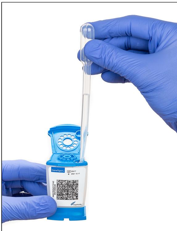
**Рисунок 6. Внесение деконтаминированного разжиженного образца в камеру для образцов картриджа**
