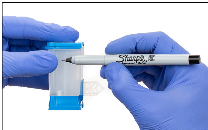
Ilustracja 1. Zapisywanie informacji na kartridżu przy pomocy markera permanentnego
