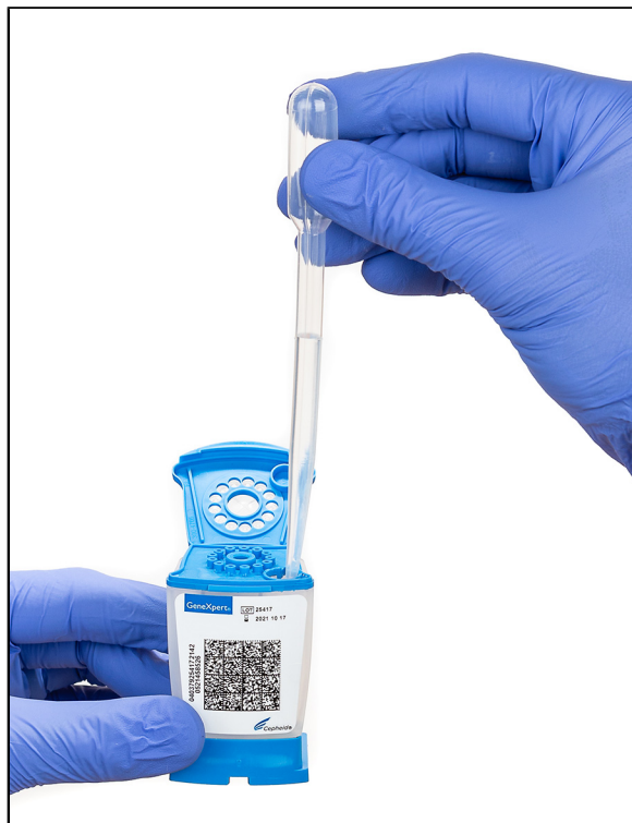
Figura 6. Dispensazione del campione liquefatto decontaminato nella camera della cartuccia per il campione
