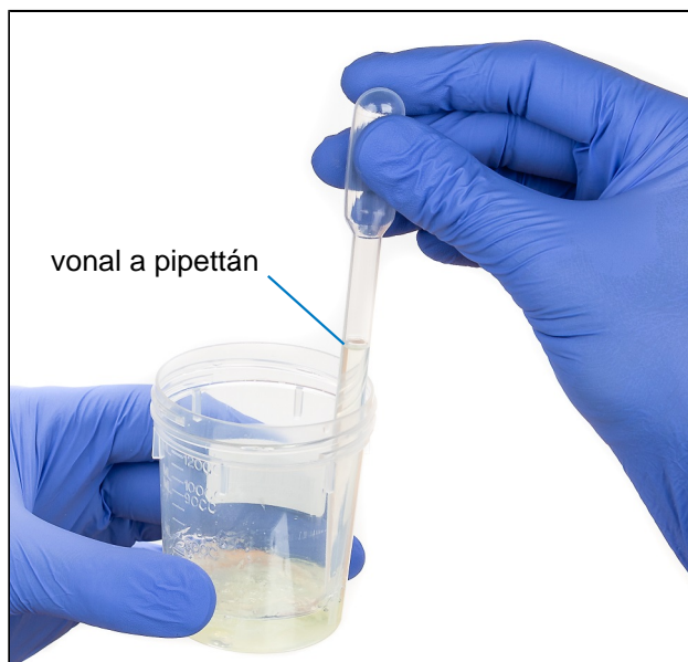
. ábra5. Felszívás a pipettán látható vonalig
