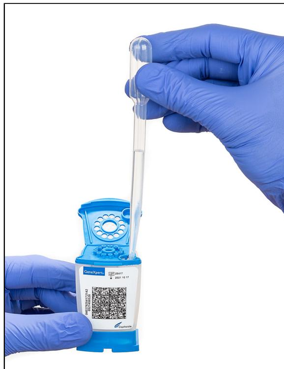
**Abbildung 6. Dispensieren der dekontaminierten verflüssigten Probe in die Probenkammer der Kartusche**
