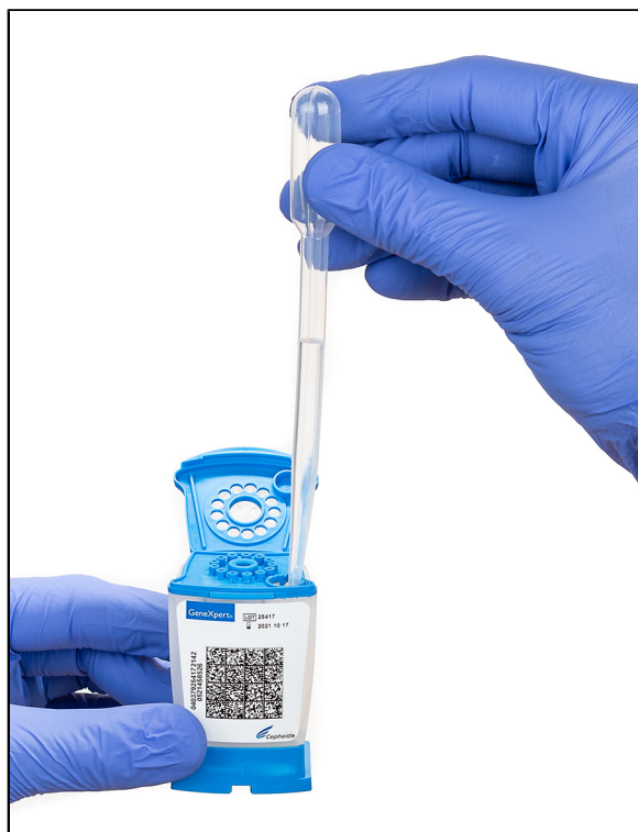
Фигура 6. Разпределяне на обеззаразена втечнена проба в контейнера за проби на касетата
