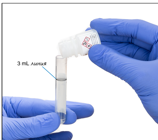
Фигура 4. Пример за разреждане 2:1 (2 mL SR:1 mL хрчка)
