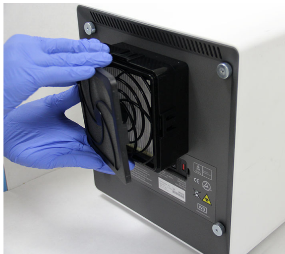
图 9-25. 取下预滤棉固定框
