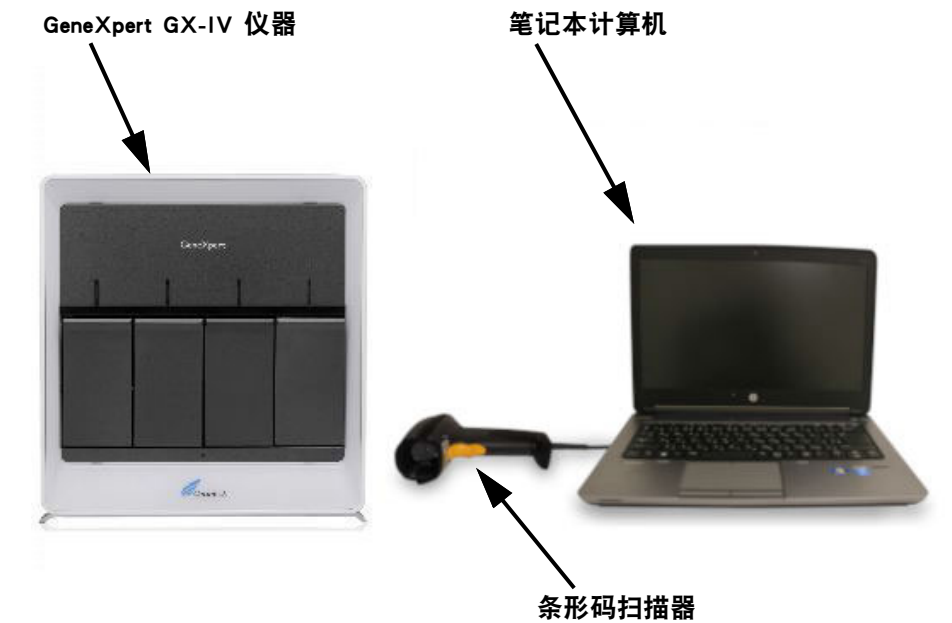
图 1-6. GeneXpert GX-IV 硬件组件 (以笔记本电脑示例)
