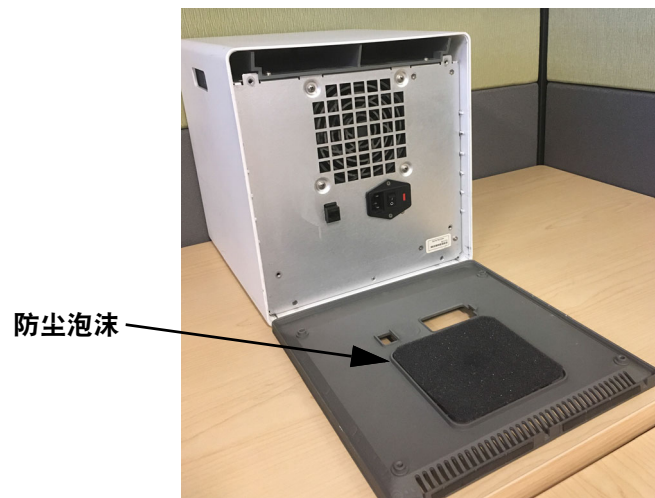
图 9-15. 老款 GX-IV 内的防尘泡沫
