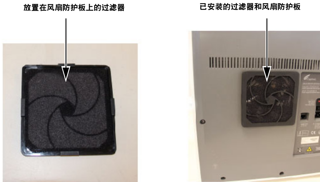
图 9-23. 更换过滤器和防护板
