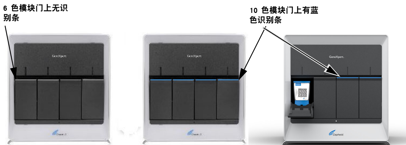
图 1-1. GX-IV 仪器示例，显示在同一台仪器中配备 6 色模块、10 色模块以及同时配备 6 色和 10 色模块
