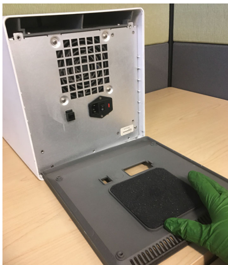
图 9-16. 更换较老款 GX-IV 内的防尘泡沫
