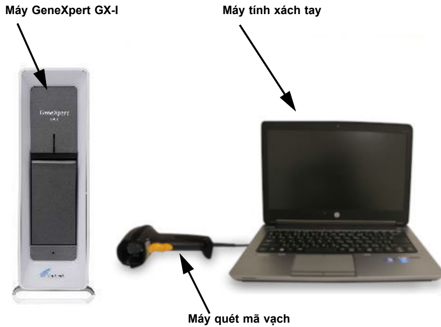
Hình 1-2. Các thành phần phần cứng của GeneXpert GX-I (Minh họa với máy tính xách tay)
