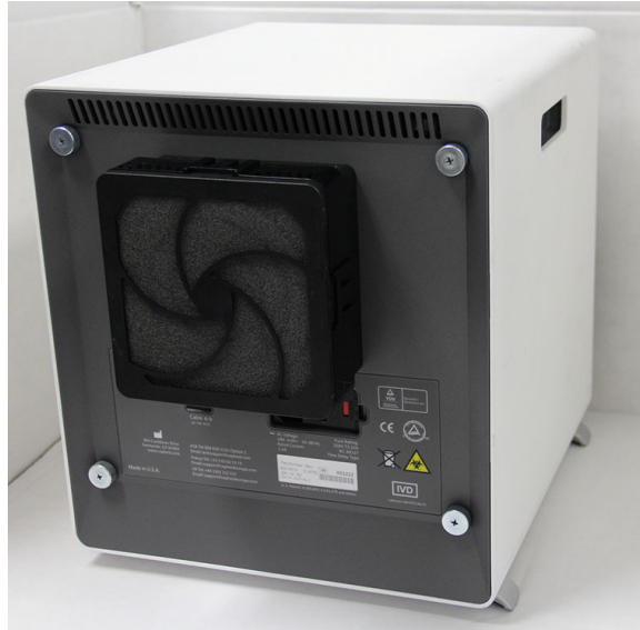
Hình 9-24. Máy GX-IV được điều chỉnh vị trí để tiếp cận bộ lọc
