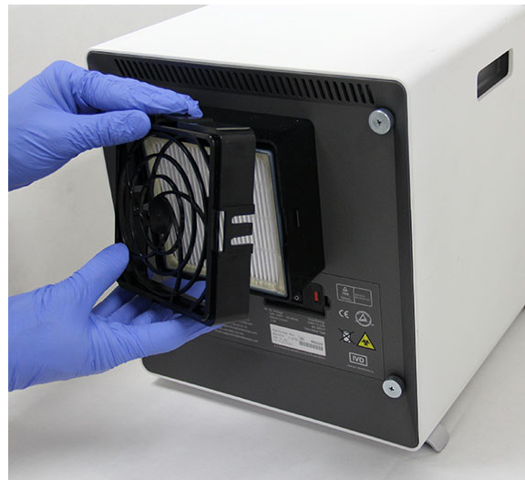
Малюнок 9-27. Видалення утримувача HE фільтра
