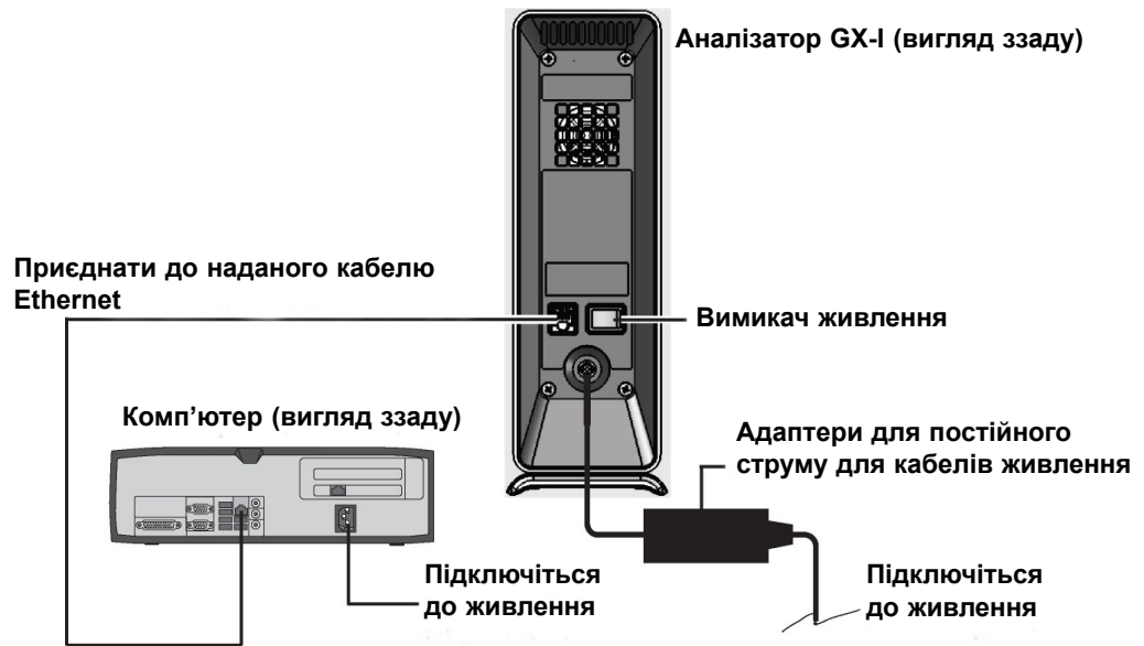
Малюнок 2-1. Підключення аналізатору GX-I до настільного комп'ютера
