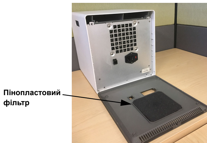
Рисунок 9-15. Пінопластовий фільтр у старій моделі GX-IV
