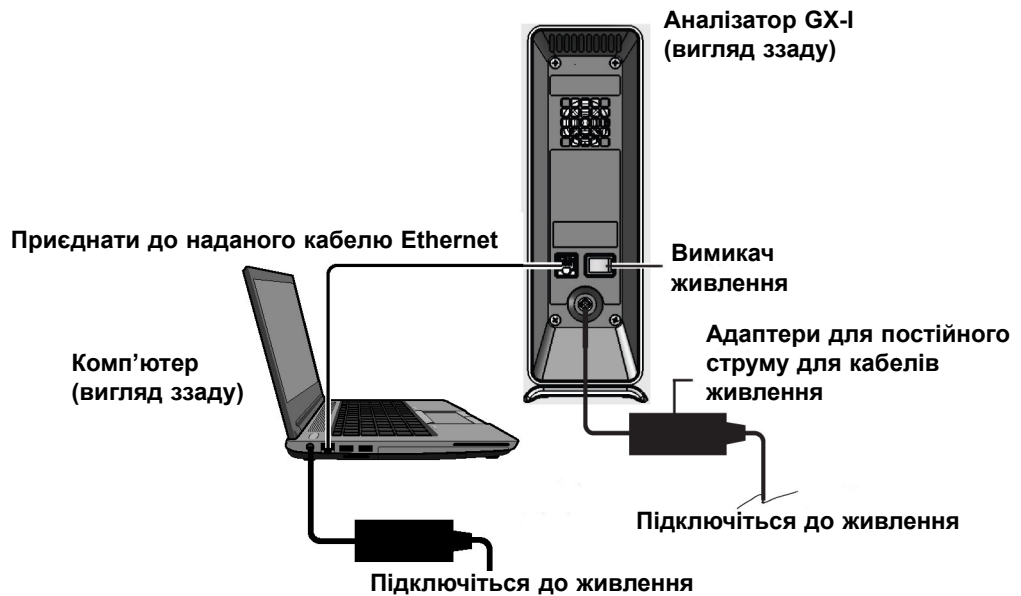
Малюнок 2-5. Підключення аналізатору GX-I до переносного комп'ютера
