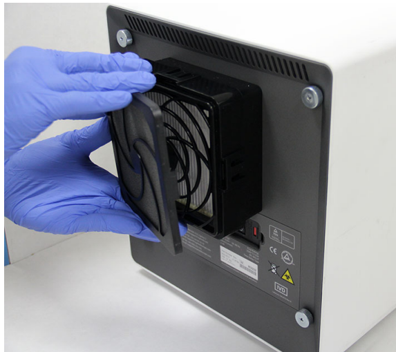
Малюнок 9-25. Видалення утримувача префільтра
