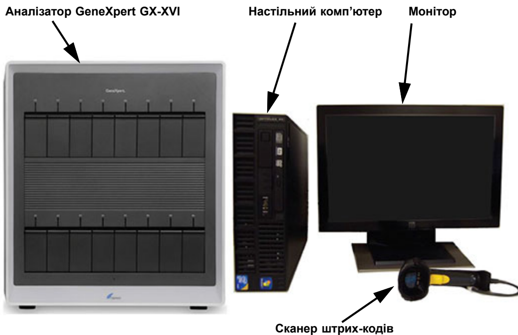
Малюнок 1-9. Апаратні компоненти GeneXpert GX-XVI (представлені разом з настільним комп'ютером)
