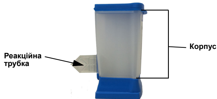
Малюнок 5-31. Зображення корпусу картриджа та реакційної трубки
