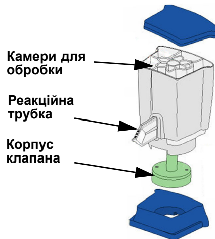
Малюнок 3-2. Складові картриджа GeneXpert
