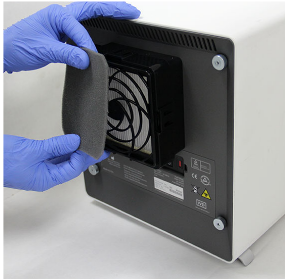
Малюнок 9-26. Видалення префільтра
