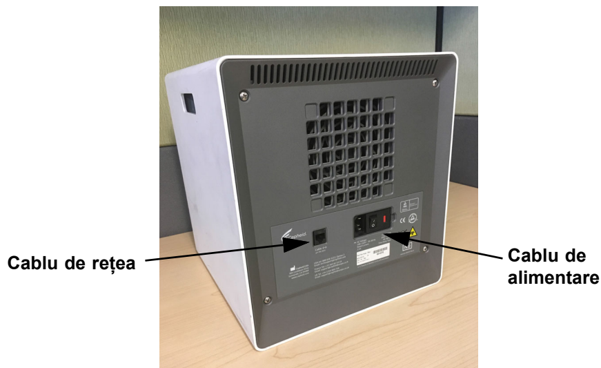
Figura 9-13. Locațiile cablului de rețea și a cablului de alimentare pe GX-IV mai vechi
