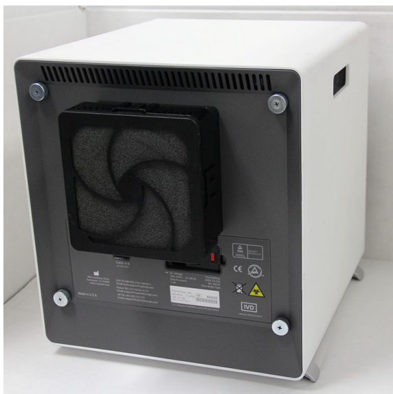
Figura 9-24. Instrument GX-IV poziționat pentru accesarea filtrului
