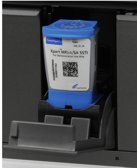
Figura 5-33. Cartușul GeneXpert, așezat la baza podelei compartimentului modulului
