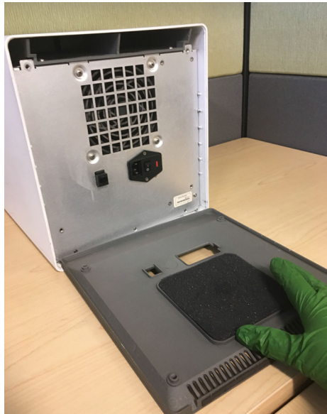
Figura 9-16. Înlocuirea filtrului de spumă din GX-IV mai vechi
