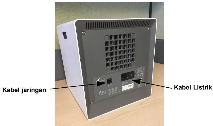
Gambar 9-13. Lokasi Kabel Jaringan dan Kabel Listrik pada GX-IV yang Lebih Tua
