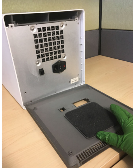
Kuva 9-16. Vaahtomuovisuodattimen vaihto vanhemmissa GX-IV-malleissa
