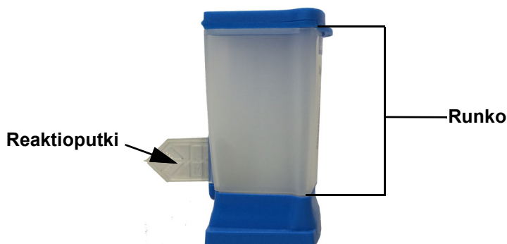
Kuva 5-31. Kasetin runko ja reaktioputki
