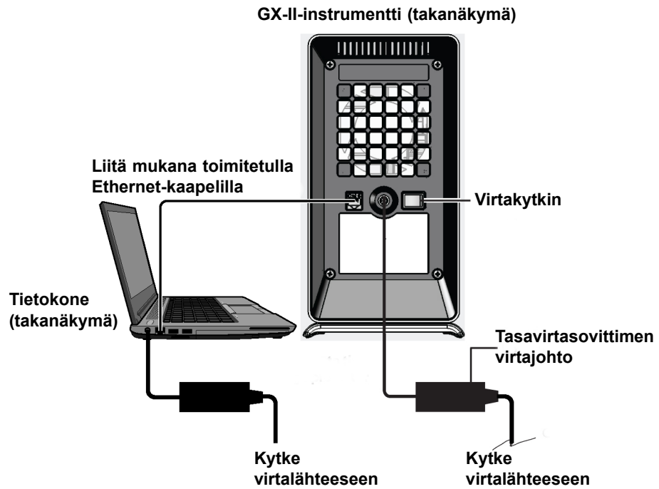
Kuva 2-6. GX-II-instrumentin liittäminen kannettavaan tietokoneeseen
