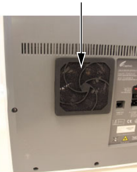
Kuva 9-23. Suodattimen ja suojuksen vaihtaminen
