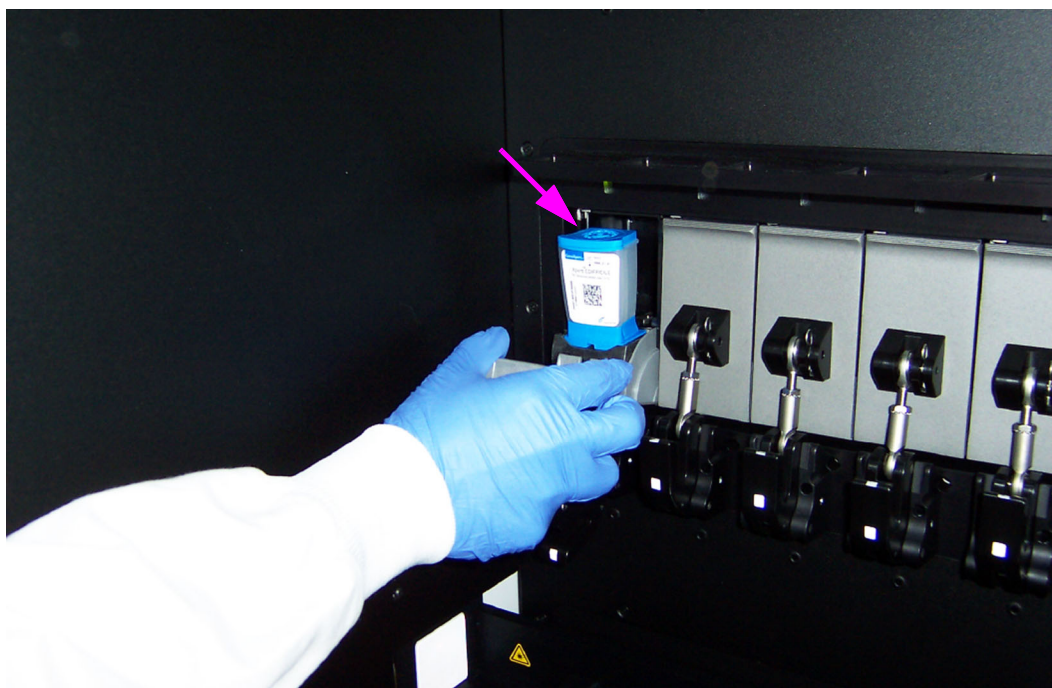
图 5-111. 将检测盒装入 GeneXpert 模块
