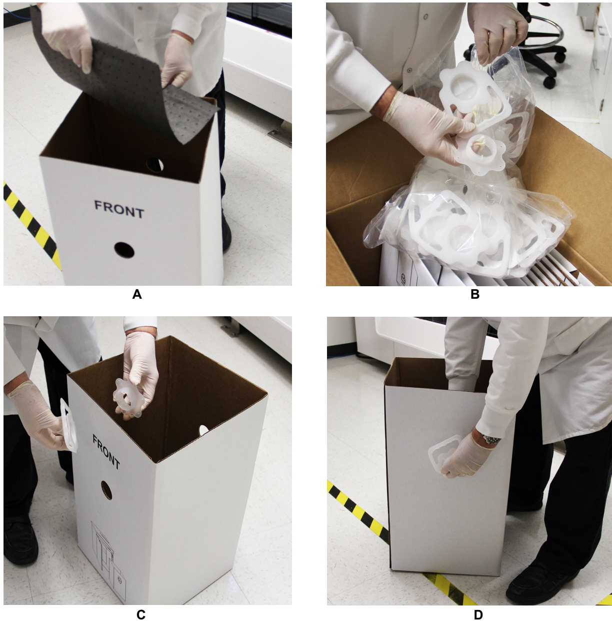
图 9-51. 组装废物容器（第 2 部分）
