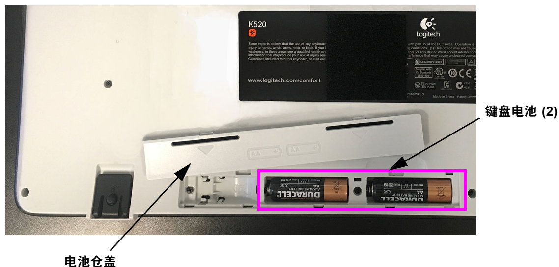
图 9-54. 键盘电池仓（已打开）
