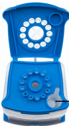
Attēls 2. Xpert Norovirus kārtidžs (skats no augšas)
